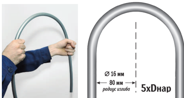
Минимальный радиус изгиба труб КОНТУР G-RAY
