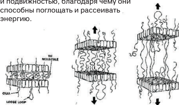
Стадии вязкой деформации полиэтилена PE-RT
